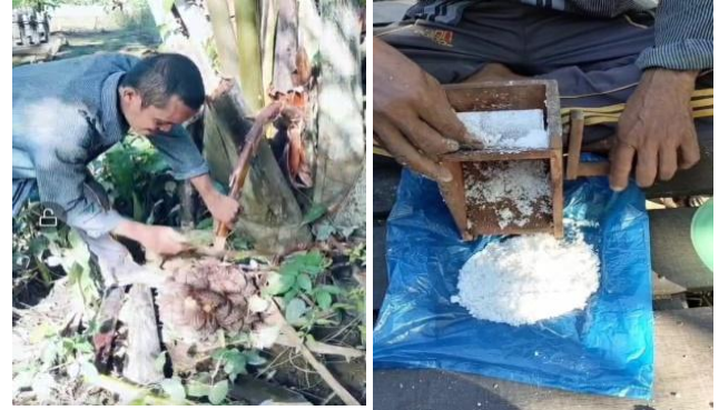
Gambar 2. Uji Coba Pengolahan Tepung Buah Nipah dengan Alat Parutan Tradisional
