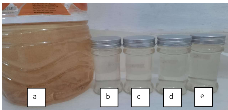
Gambar 5. Air gambut (a) sebelum pengolahan (b) pengolahan dengan SBEC, (c) pengolahan dengan magnetik karbon/clay variasi 1, (d) pengolahan dengan magnetik karbon/clay variasi 2, (e) pengolahan dengan magnetik karbon/clay variasi 3.
