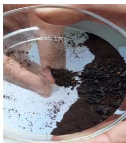
Gambar 3. Uji kemagnetan dengan medan magnet
